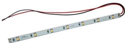
Placa lineal de 200x8mm en fibra de vidrio. Con adhesivo a doble cara para fijación. Con 7 led 2835 SAMSUNG 3000K CRI90 120Lm/W. Cableada con 50cm de cable AWG22 rojo (+) y negro (-). La conexión a la placa de control se hace con conectores de pin a presión. Según se haya seleccionado en la placa de control la luminosidad será de 150lm (1.3W) o de 250lm (2.1W). Todas las placas led están diseñadas para funcionar exclusivamente con módulos a batería.
