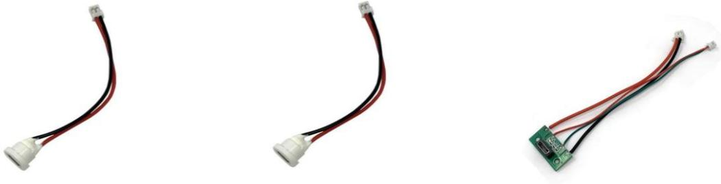
**Código G5K000P5:** Micro-B USB montado sobre soporte redondo blanco de 12mm de diámetro y 7 mm de altura con 10cm de cable AWG22 y conector.
