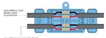
cavo d'ingresso separato 2 poli separate cable in 2 conductors controller DALI (bassa tensione AC) oppure linea DALI proveniente da un altro apparecchio controller DALI (low voltage AC) or DALI line arriving from another lighting fixtures
