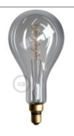
Hauteur (mm): 300 Diamètre (mm): 165 Tension In (Vac): 220~240 Puissance (W): 5 Température de couleur (°K): 2000 Lumens: 150 Angle (°): 360 Culot: E27 Efficacité énergétique: G Kwh/1000h: 5 CRI (?): 80 Vie (Heures): 15000
