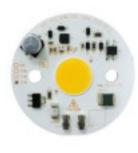
Led Cob EDC/57C/12W/940/230V/F201 ECO diseño segun directivas ERP. Conectores automáticos. Dimmables por corte inicio o fin de fase.
