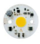
Led Cob EDC/57C/12W/927/230V/F201 ECO diseño segun directivas ERP. Conectores automáticos. Dimmables por corte inicio o fin de fase.
