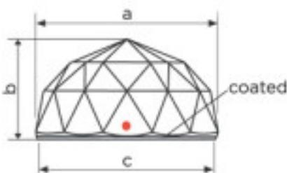
Efecto CAL V SI. A=29,6mm (+/-0,3mm); B=16,5mm (+/-0,3mm); C=28,3mm (+/-0,3mm)
