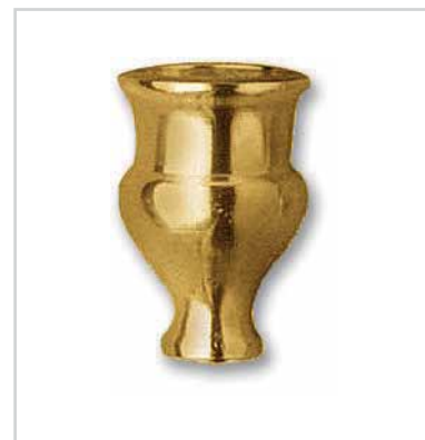
19-005 Ø31 x H45 filetto/thread M 10/1 piano sotto/lower flat Ø17 foro interno/internal hole Ø22,5
