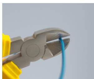
Corte de cable unipolar y mangueras de 2,3 y 4 cables.
