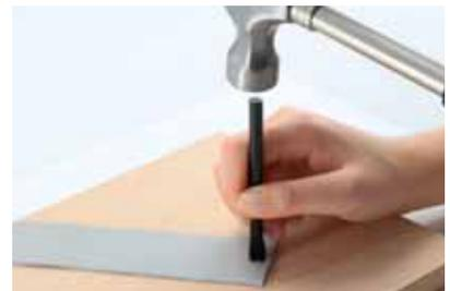
9 Realice el orificio para botón con una herramienta de perforación para botones (art. 9040/122).
