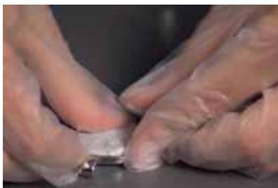
1 Coloque la arcilla en la zona pertinente y presiónela. Asegúrese de que no queda aire entre Ceralun y el material base.
