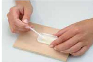
2 Mezcle bien los dos componentes hasta lograr una apariencia homogénea.
