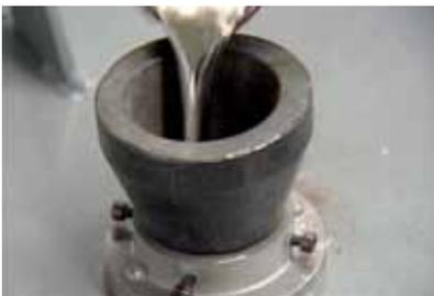
4 Los moldes de caucho terminados se presionan entre sí y se rellenan con la aleación de metal fundido (procedimiento de fundición centrífuga).
