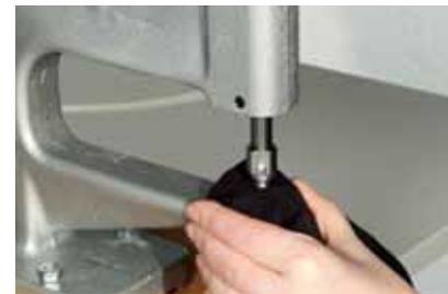
3 Aplique el producto en el material de base. Regule la compensación/presión utilizando el tope ajustable.
