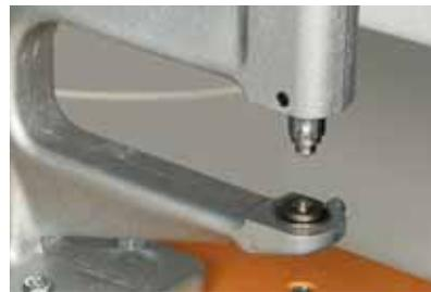
2 Coloque la pieza decorativa en el troquel superior y la base convexa en el troquel inferior. La aspiración mantendrá la pieza decorativa en la posición superior durante la aplicación.
