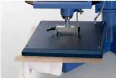
4 Una vez configuradas la presión, el tiempo y la temperatura, cierre la prensa térmica.
