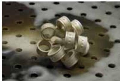
8 Tras la fundición, la cubeta caliente se sumerge en agua fría. A continuación, se limpia el árbol de fundición.
