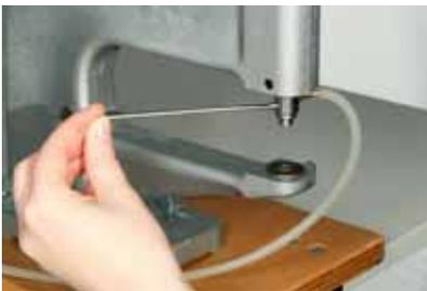
1 Coloque el adaptador de vacío y las herramientas en la remachadora. Asegúrese de que están bien fijados y conecte el adaptador de vacío a la bomba de aspiración.
