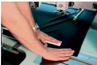
4 Una volta sistemati rocchetto e filo, fissare in posizione il tessuto mediante colla spray.
