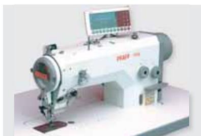
Una **macchina da cucire industriale** è adatta alla maggior parte delle applicazioni tramite cucitura. Per l'applicazione di particolari prodotti Swarovski, è tuttavia necessario utilizzare una macchina dotata di un programma per punti zigzag.
