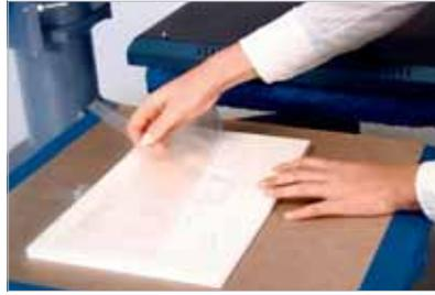
6 Una vez finalizada la aplicación, utilice un tejido de presión o un guante resistente al calor para aplicar presión adicional.
