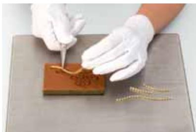
2 Colocar la Cupchain en el molde de soldadura.
