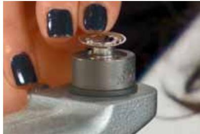
2 La arandela de soporte, con la superficie redondeada hacia abajo, se desliza entonces por encima del vástago de la base.
