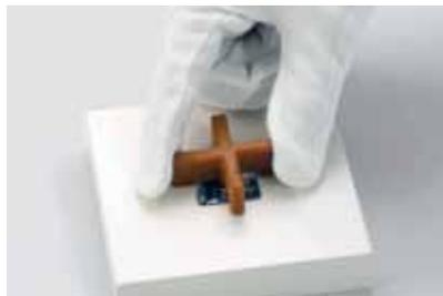
Una cruceta (o herramienta similar) evitará que el cristal se vuelque. Presione el cristal hacia el material con la herramienta elegida.
