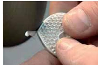
6 El modelo fundido obtenido mediante este proceso se pule para prepararlo para el proceso galvanizado.
