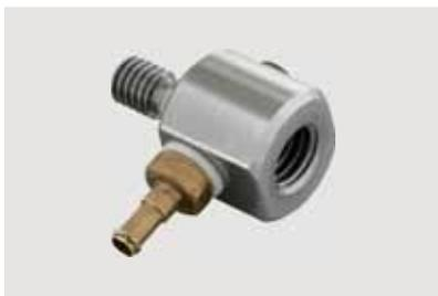
**Adaptador de vacío** con rosca exterior M6 para fijar a la remachadora y rosca interna M8 para sujetar el troquel superior (art. 9040/023).
