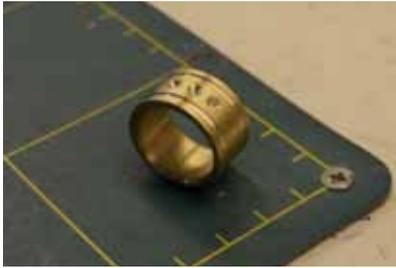
1 Producción de un prototipo (por ejemplo, creación de un prototipo rápido); cuanto mejor sea la calidad de la superficie, mejor será el recubrimiento posterior. Debe tenerse en cuenta la contracción durante la fundición.
