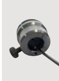
2 Utilice el pasador de cambio para deslizar lentamente la pieza de plástico fuera del troquel de fijación desde arriba, a través del orificio.
