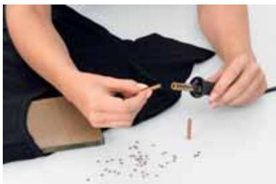
1 Escoja un aplicador que coincida con el tamaño del cristal –de manera que el cristal no se incline y se salga de su lugar– o utilice un punto de aplicación plano.
