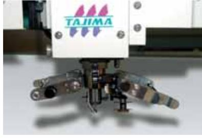
La **testina per punto a spola** è ideale per l'applicazione di elementi Plastic Trimming a fila singola.
