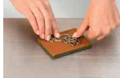
3 Presionar el modelo original en un material de impresión adecuado.
