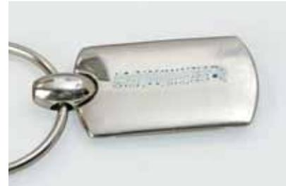
3 Si la tinta desaparece o forma burbujas, la superficie no es apta para el pegado. En este caso, deben verificarse los métodos de limpieza del tratamiento previo.
