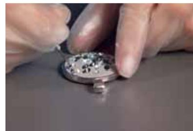
3 Recoja el cristal con un sistema de recogida por aspiración, o bien con un par de pinzas o un bastoncillo de cera. Coloque cuidadosamente el cristal y presiónelo ligeramente hacia abajo.
