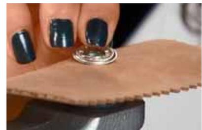
3 El material, ya perforado, ahora descansa sobre el conjunto de la base de cristal y la arandela de soporte. Se deberá tener cuidado de realizar la aplicación en el lado correcto de la tela. Ponga el lado trasero hacia arriba. El siguiente paso consiste en colocar la segunda arandela de soporte en el material de soporte, con la sección redondeada hacia arriba.
