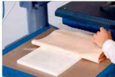
5 Limpie con cuidado las superficies de contacto de la prensa térmica mientras esté apagada. Coloque el material de base en la prensa térmica y defina los parámetros de aplicación. Asegúrese de utilizar los materiales de ayuda apropiados.
