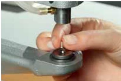
4 Coloque la parte inferior de Crystal Stud en el troquel inferior.
