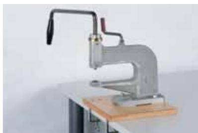
La **remachadora** (art. 9040/019, con tablero de montaje) es una forma fácil de aplicar mecánicamente los productos.
