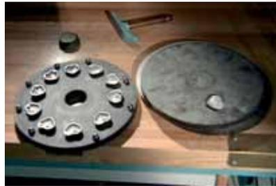
2 Estos modelos originales se presionan contra un molde de caucho. El molde de caucho se somete a vulcanización para crear un modelo de fundición de caucho.
