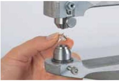
1 Coloque el Decorative Button/parte superior del Snap Fastener en el troquel inferior, con las garras hacia arriba.
