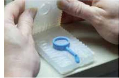
3 Una vez creado el molde se inyecta la cera fundida con un inyector para crear un modelo de cera.
