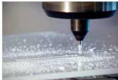
2 Frese las cavidades utilizando una fresa especial de 90° con un diámetro apropiado para el elemento seleccionado. A continuación, limpie con cuidado la superficie utilizado aire comprimido libre de grasas.
