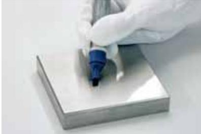
1 Las superficies que se van a pegar deben pretratarse adecuadamente para conseguir una tensión de superficie suficiente. Esto puede probarse con un Test Pen.
