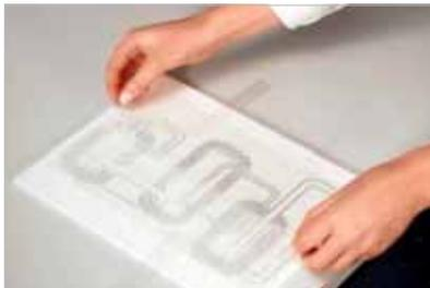
4 Despegue la película protectora de color blanco del Diamond Transfer y coloque este último en la posición deseada sobre el material de base. La película de transferencia descansará también sobre las pequeñas láminas de transferencia.
