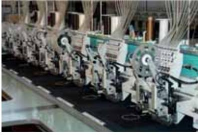
A seconda del tipo di prodotto da applicare, è possibile utilizzare varie **macchine da ricamo completamente automatiche**.
