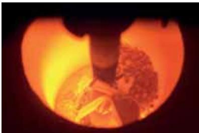
7 Mientras aún está caliente, se rellena la cubeta con el metal fundido. Debido a la porosidad de la forma, el metal fundido la cubre por completo.
