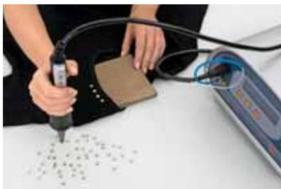
2 Posicione el cristal sobre el material de base, que deberá descansar sobre una base sólida (por ejemplo, vidrio o metal).
