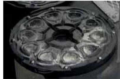
3 A continuación se crean bebederos en la plancha de caucho para el proceso de fundición.
