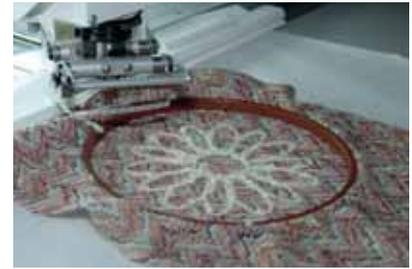
Un **telaio** consente di stabilizzare la stoffa sottile ed elastica durante lavorazioni di ricamo industriali.
