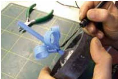
4 Las formas de cera creadas de esta forma se funden cada una en un formato de árbol de cera con un dispositivo de soldadura de cera. El tronco del árbol de cera sirve después como el canal de fundición.
