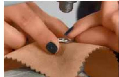
3 El material, ya perforado, ahora descansa sobre el conjunto de la base y la arandela de soporte. Vuelva a comprobar que se trata del lado correcto de la tela. Ponga el lado delantero hacia arriba. El capuchón metálico abierto, con la superficie redondeada hacia arriba, se desliza por encima del vástago de la base hasta el material de soporte. Regule la presión utilizando el tope ajustable.
