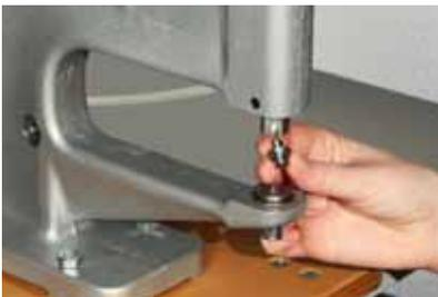
1 Vuelva a colocar los troqueles superior e inferior para aplicar el cierre Snap Fastener. Coloque la parte de bola en el troquel superior (que se mantendrá en su posición por aspiración) y la parte contraria en el troquel inferior.
