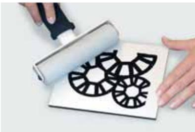
4 Una vez seca, presione de nuevo firmemente sobre el motivo (por ejemplo, utilizando un rodillo de caucho).
