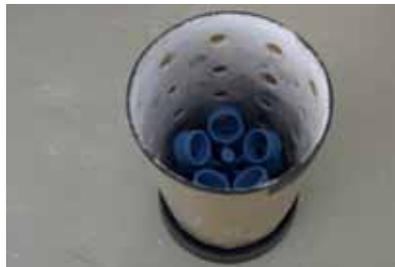
5 El árbol se coloca ahora en una cubeta, tras aplicar pegamento en los orificios, y se sumerge en pasta de implantación en condiciones de vacío y vibración.
