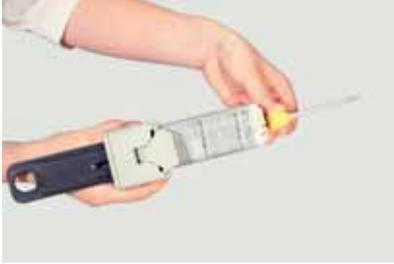
Al utilizar el pegamento de la **caja de 750 g**, es necesario mezclar la resina y el endurecedor. Primero, pese los dos componentes en una proporción de 2 a 1 (resina: endurecedor). Es muy importante mantener unas proporciones exactas al mezclar los dos componentes para conseguir la máxima adhesión. A continuación, mezcle bien los componentes durante al menos un minuto, ya que solo una mezcla completamente homogénea produce los resultados deseados.
