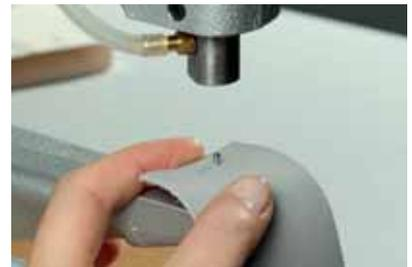
6 Coloque el material de base con el orificio previamente perforado en la parte inferior.
