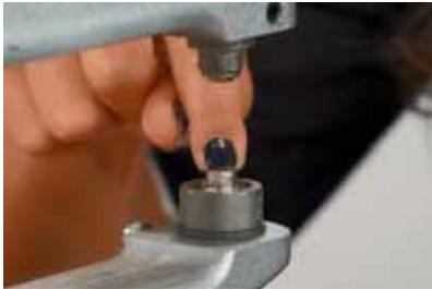
1 Inserte los troqueles necesarios en la remachadora. Primero, coloque la base — con el vástago hacia arriba— en el troquel inferior. Asegúrese de que repose con firmeza en el troquel inferior.
