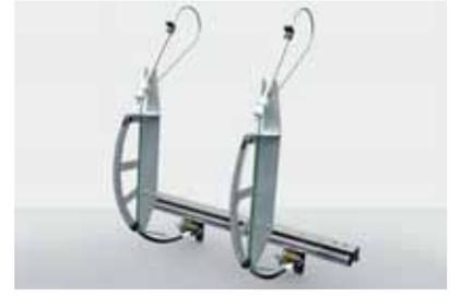
Utilizzare un dispositivo come il **Laesser Crystal Stone Head** per macchina da ricamo Schifflì (o il **dispositivo da ricamo Lochrose** di Tajima) per applicare in modo completamente automatico elementi Lochrose art. 3129.
