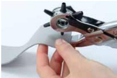
1 Realice la perforación previa del material en la posición designada para Crystal Stud.
