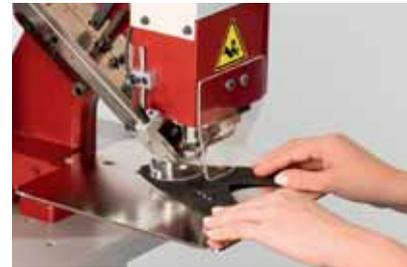
3 Coloque el material de base y realice la aplicación.
