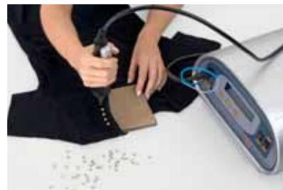
3 Presione el adaptador firmemente contra el cristal en un ángulo perpendicular y active el dispositivo.
