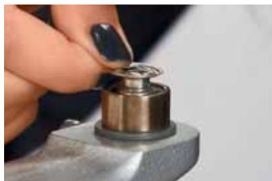
2 Deslice una arandela de soporte —con la superficie redondeada hacia abajo— por encima del vástago de la base.
