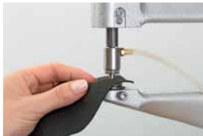
2 Coloque el material de soporte y realice la aplicación.
