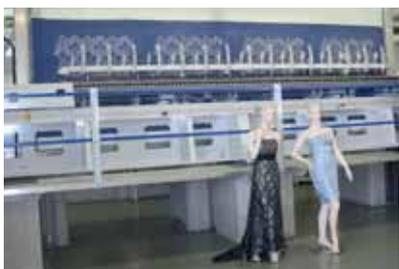
4 Il ricamo viene eseguito automaticamente sfruttando un sistema come il Laesser Crystal Stone Head (nella foto) o il dispositivo da ricamo Lochrose di Tajima.
