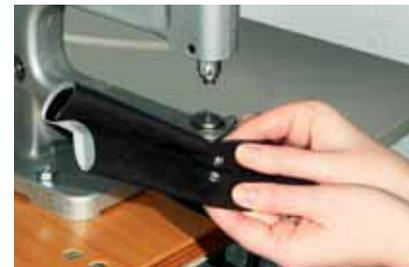
3 Regule la compensación/presión utilizando el tope ajustable. Tras la aplicación, compruebe que los Snap Fasteners funcionan correctamente.
