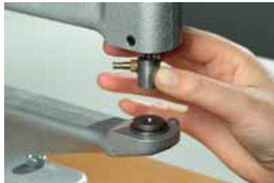
2 Coloque las herramientas en la remachadora. Asegúrese de que se han asentado de manera firme y nivelada.
