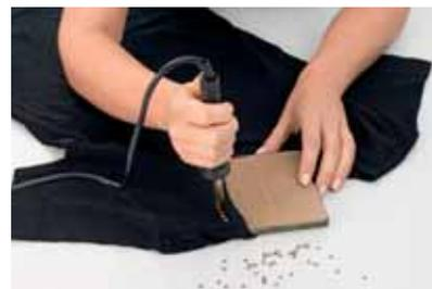
3 Tan pronto como el adhesivo Hoflix de la parte trasera del cristal se haya fundido, coloque el elemento sobre el material de base, que deberá estar situado sobre una base sólida (por ejemplo, de vidrio o metal).
