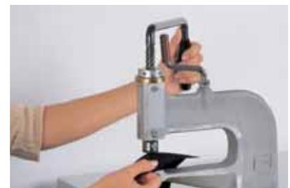
3 Realice la aplicación en la posición deseada. Regule la presión utilizando el tope ajustable.
