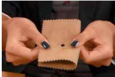
2 Se deberá tener cuidado que el proceso de pre-perforación se realice en el lugar exacto donde se pretende aplicar el Inset Snap Fastener. La parte delantera y trasera de la tela pueden perforarse en una única operación.
