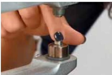
1 Cambie solo el troquel inferior. El troquel superior se utiliza para aplicar tanto la parte delantera como la trasera. Inserte la base de cristal en el troquel inferior con el vástago hacia arriba y el cristal hacia abajo.
