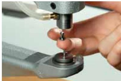
5 Coloque la parte inferior en el troquel superior (con el cristal apuntando hacia arriba).
